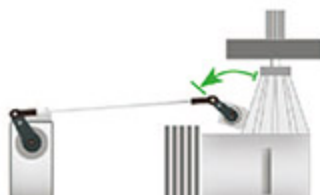
MAX RPM 最大轉速 Move throttle to maximum position 移動油門到最大行程量
