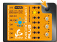
Status LED blue when throttle position registered 開啓油門位置時，Status-LED 燈亮藍色
